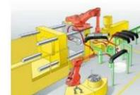
Il robot da controllare, dotato di quattro motori, si muove su tre assi, orizzontale (indietro e avanti), verticale (su e giù), rotazione (orario e antiorario). E' prevista inoltre una pinza di presa dei pezzi (apri e chiudi). Tra parentesi le denominazioni scelte per gli otto movimenti possibili. Tali movimenti sono comandati dalle prime otto uscite del controllore.
