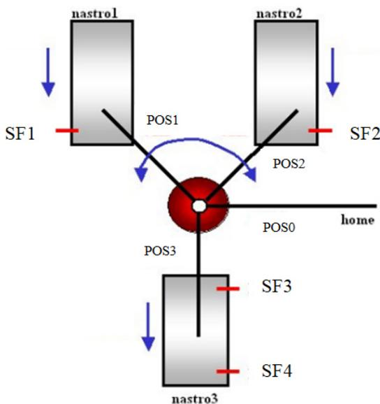
Il sistema è costituito da tre nastri trasportatori con motori M1, M2, M3. I nastri si muovono in una sola direzione, mentre un robot con braccio meccanico mobile ruota in senso orario e antiorario.
